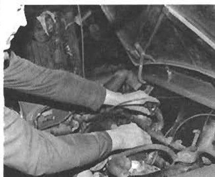
19. Sie können dann den Motor etwas nach vorne ziehen, während der Krümmer in seine Lage jongliert wird.
