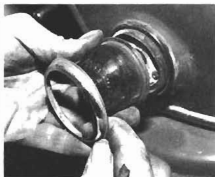
18. Das darunterliegende Glas sitzt ebenfalls in der Gummihaltelippe, läßt sich aber meist einfacher lösen.
