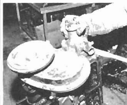
79. Hebeln Sie die Pumpe ab. Den Hebel keinesfalls zwischen den Paßflächen ansetzen.
