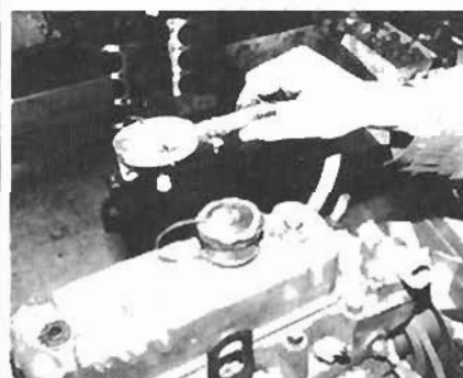
44. Der Entlüfterschlauch (sofern vorhanden) sitzt etwa hier auf dem Ansaugkrümmer — hier wurde er entfernt. Der Gummischlauch führt...
