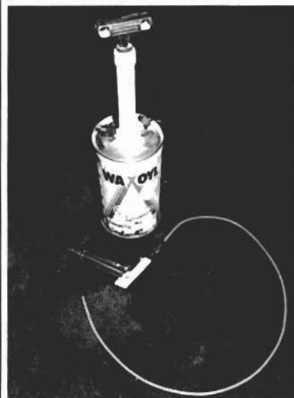
4. Diese Version des Sprühwerkzeugs (mit unter Druck stehendem Behälter und Sprühpumpe, ähnlich einer Garten- spritze) kann beliebig oft nachgefüllt werden.
