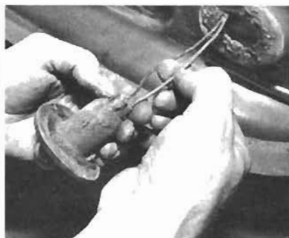
21. Die Kabel abziehen. Kratzen Sie mit dem Fingernagel am Kabel, um festzustellen, ob die Isolation brüchig ist (das Kabel ist unter ständigem Beschuß durch Straßenschmutz) und die Kabelfarben noch sichtbar sind. Ggf. Kabel mit Klebeband kennzeichnen.
