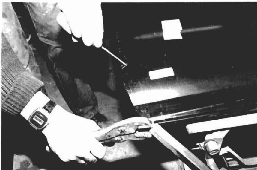
19. Die Türhaut muß überall exakt passen (hier und da muß man die Falze evtl. etwas zurückbiegen). Die Kanten des Türrahmens müssen jetzt evtl. nachgerichtet werden. Dann spannen wir das Blech mit Gripzangen fest.
