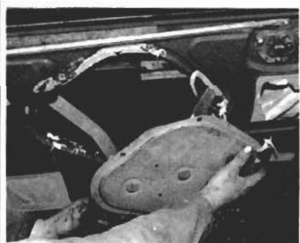
4. Ziehen Sie den Kurbelapparat (Zeichnung 6, 4) vom Türblech soweit nach vorne weg, daß der hintere Kurbelarm aus der Fensterkurbelschiene freikommt.
