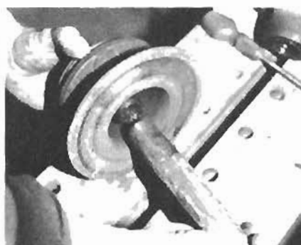
16. Durch leichte Schläge rutscht sie von der Antriebswellenaufnahme.
