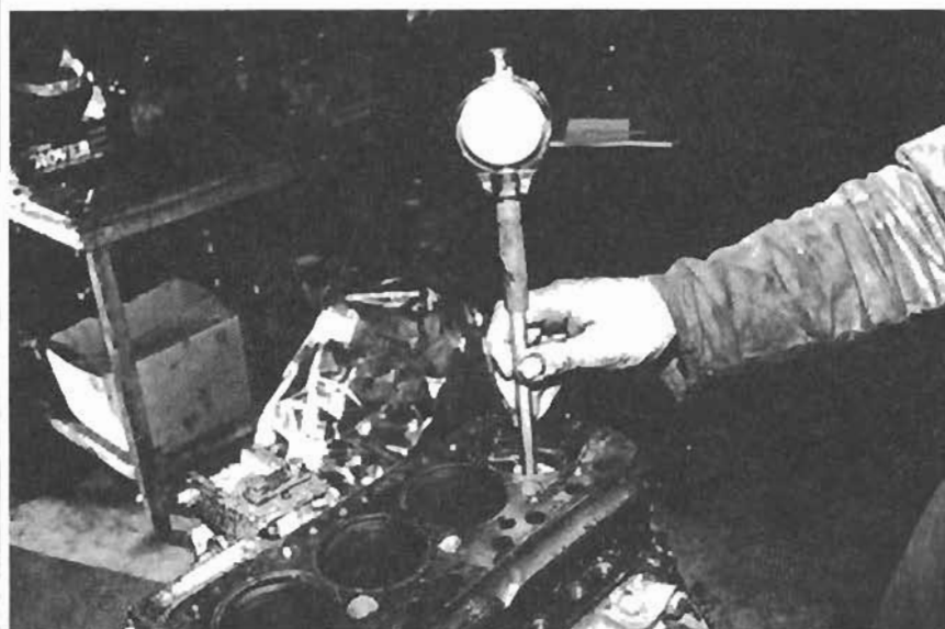
109. Die Bohrungen laufen natürlich aus. Hier werden sie mit einem Innenmikrometer mit Meßuhr überprüft. Das Mikrometer wird senkrecht eingeführt, die Meßuhr auf Null gestellt und das Mikrometer dann auf- und ab- und im Kreis bewegt. Die Federauflagen, die an der Wandung anliegen, zeigen Plus- oder Minusabweichungen exakt an.
