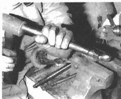
18. Mitunter verklemmt sich der Kugelkopf am Ende des Federtopfes und muß dann mit einem Messingdorn herausgetrieben werden. Bei starkem Pitting ist ein neuer Kugelkopf fällig.
