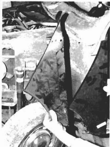
5. Links ist das neue innere A-Blech, rechts das äußere Blech zu sehen. Das rechte Blech ist für ein neueres Baujahr (die Scharnierlöcher fehlen hier).
