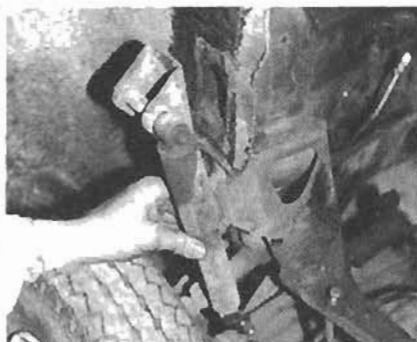
18. Der vordere Stoßdämpfer ist an einfachen Buchsen oben und unten eingesetzt; der komplette Haltewinkel kann ggf. ausgebaut werden.
