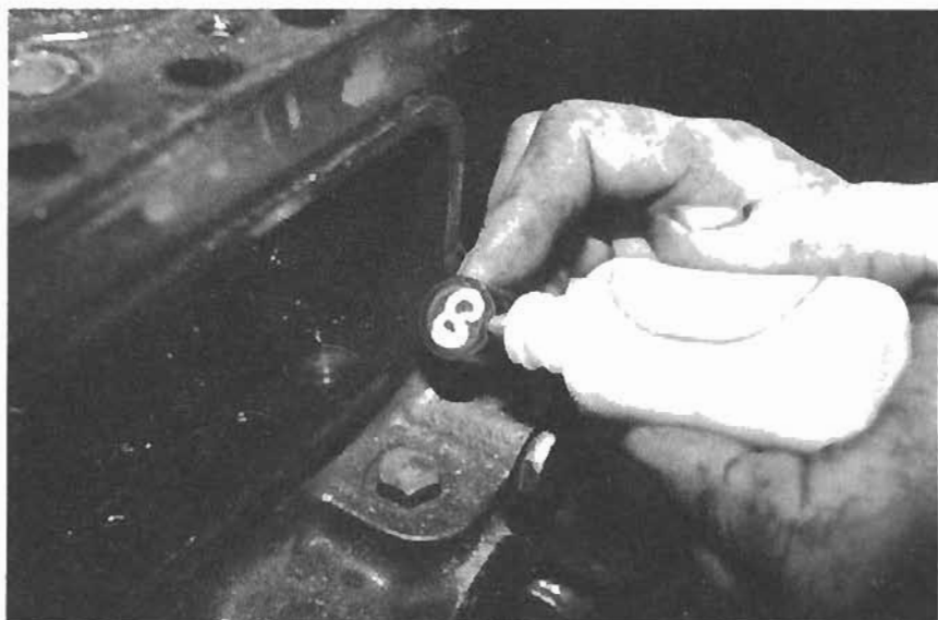
48. Untersuchen Sie die Lauffläche des Stößels auf Pitting (in diesem Fall die Stößel erneuern) und dann durchnummerieren, damit sie nicht verwechselt werden.
