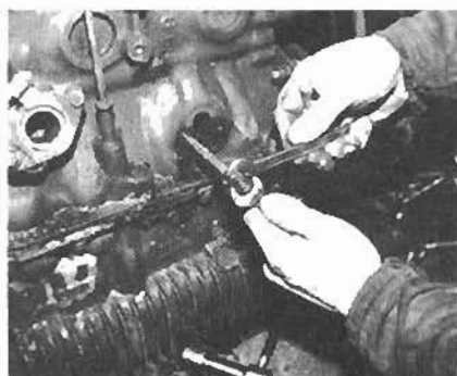
6. Zum Ausdrehen der Stiftschrauben dreht man zwei Muttern auf das Gewinde auf, kontert sie und dreht die untere Mutter linksherum heraus. Die Mutter bleiben dabei fest aufgeschraubt; stattdessen wird die Stiftschraube herausgedreht.
