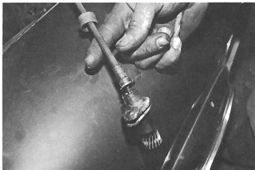
27. ... die Schraube lösen, die die normalerweise unzugängliche Tachowelle am Getriebe hält.
