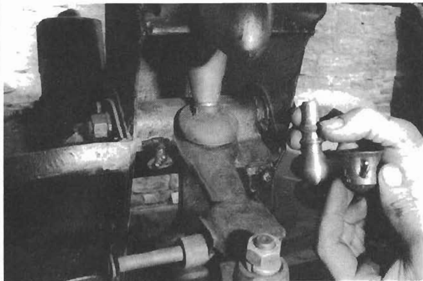
21. Am unteren Ende des Vorderachs-Federtopfes (von der Gummimanschette verdeckt) sitzen ein Kugelbolzen-gelenk und eine Kugelpfanne (ähnlich wie an der Hinterachse). Die hier gezeigte Kugelpfanne wurde beim Ausbau beschädigt.
