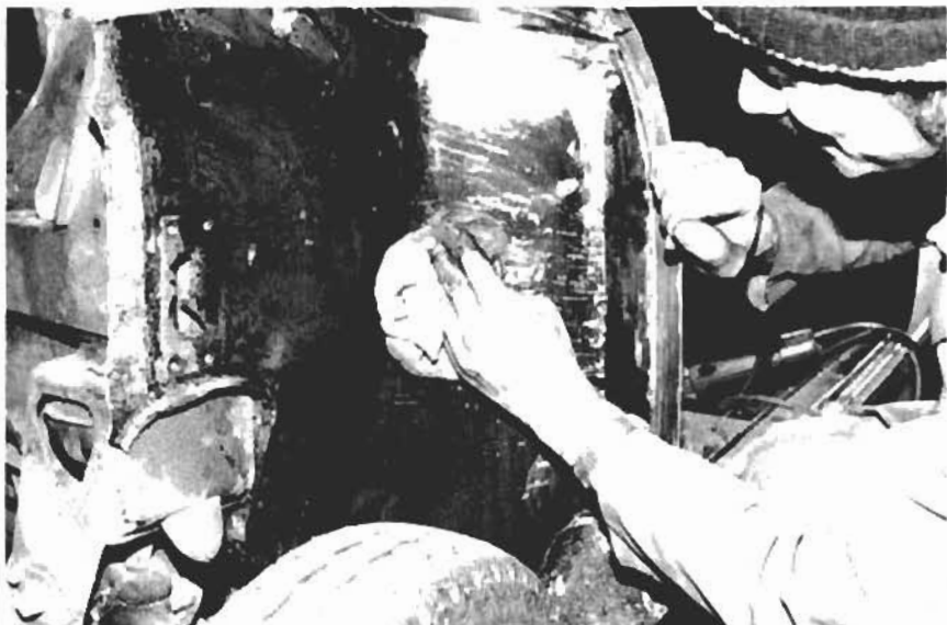
31. Das Blech mußte mit dem Hammer nach oben nachgerichtet werden, so daß es richtig anlag.
