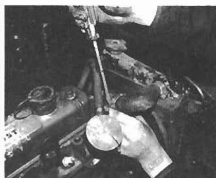
10. Dann wird der obere Schlauch vom Thermostatgehäuse abgeschraubt...
