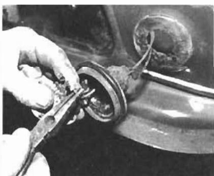
23. Mit einer langschenkligen Spitzzange ziehen Sie die Kabel von ihren Kontaktstiften ab...
