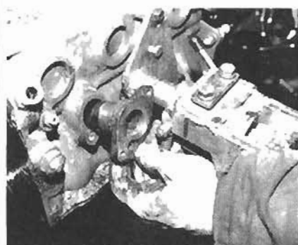
73. Nachdem die Schraube gelöst wurde, kann das Gehäuse aus dem Block herausgezogen werden.
