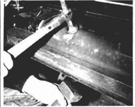
17. Der Türfalz muß mit Hammer und Handfaust auf der gesamten Länge gerichtet und geglättet werden, bevor die neue Türhaut aufgezogen wird. Wenn man am Falz entlangblickt, fallen Wellen und Beulen sofort auf.
