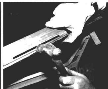
25. Genauso wird der obere Falz langsam umgehämmert...
