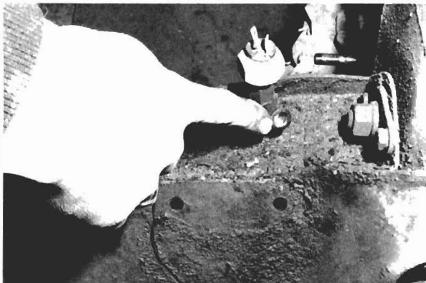
4. Die Bremsleitung muß an der Verbindung zwischen Karosserie und Bremslichtschalter auf dem Hilfsrahmen (einige Minis haben einen mechanischen Bremslichtschalter) gelöst werden. Die Kabel werden am Bremslichtschalter abgezogen. Der Kupplungsnehmerzylinder wird zweckmäßigerweise vom Motor abgebaut, bleibt sonst aber unangetastet.
