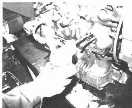
5. Ziehen Sie den Ölfilter komplett mit seiner Aufnahme ab. Jetzt kann das Öl aus dem Filter ausgegossen werden.
