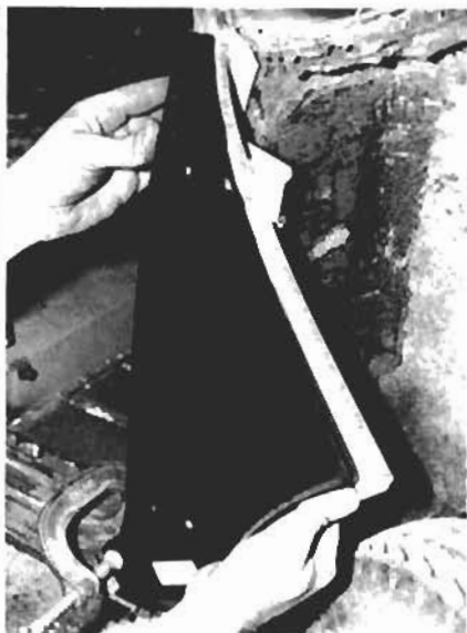
7. Hier wird das originale Außenblech angehalten und ein Nachbauteil eingepaßt. Ein klassischer Fall von nicht passendem Nachbauteil — der gekrümmte untere Teil steht weit über das Originalteil über und hätte sich nur mit erheblichem Aufwand passend machen lassen.
