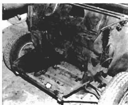
3. Der vordere Hilfsrahmen muß bei größeren Eingriffen an der Bugpartie unbedingt montiert bleiben. Er dient als Bezugspunkt für den richtigen Zusammenbau. Bei Schäden an tragenden Teilen im vorderen Wagenteil kann sich der Hilfsrahmen verschieben, wenn alle Karosserieteile demontiert wurden. Messen Sie daher vom Querträger (Pfeil) am Hilfsrahmen zu einem festen Bezugspunkt an der Spritzwand vor Abbau der Karosserieteile und auch hinterher.
