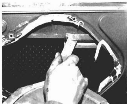
5. Dann ziehen Sie den Kurbelapparat nach hinten, so daß der vordere Arm aus der Kurbelschiene freikommt.
