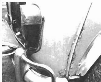
25. Die Rückleuchten sind bei allen Modellen mit drei Schrauben mit Muttern befestigt, die innen im Kofferraum zugänglich sind. Ihre Steckverbinder sitzen innen im Kofferraum hinten in Bodenblechnähe.
