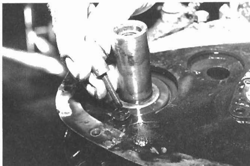
91. Die Nockenwelle kann jetzt oder nach dem Abbau des Motorstirndeckels ausgebaut werden. Hier wird zuerst der Stirndeckel abgebaut. Bei Duplexsteuerketten ist der Stirndeckel mit Inbus-schrauben befestigt, so daß Platz für die Abstandskette bleibt. Die meisten Motoren hatten eine einfache Steuerkette. Der Deckel ist dann mit normalen Schrauben angeschraubt. Alle Schrauben herausdrehen...
