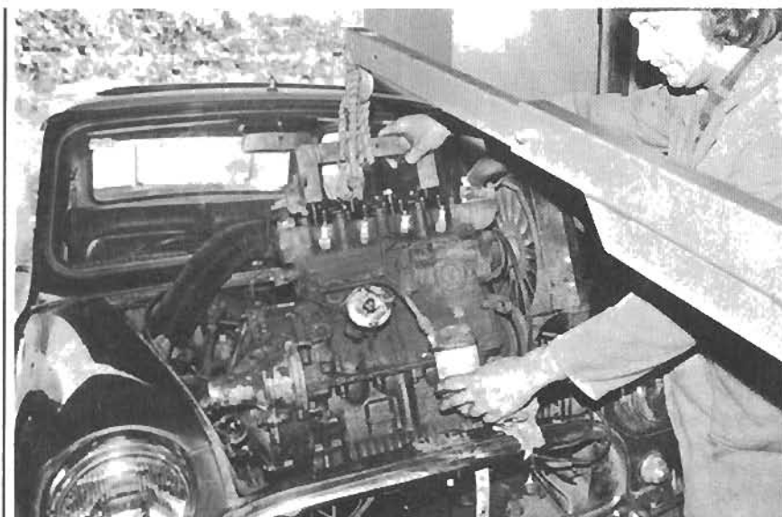
26. Den Motor etwas anheben und nochmals prüfen, ob alle Haltetrossen fest sitzen...
