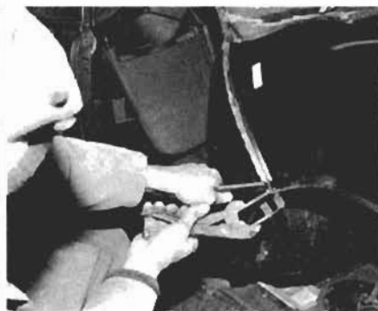
15. Der neue Kotflügel wird mit Schweißzangen angeklemmt bzw. mit Blechschrauben befestigt (falls der Wagen anderswo geschweißt wird). Lassen Sie sich NICHT dazu verleiten, den Kotflügel nur mit Blechschrauben zu montieren — dies ist als dauerhafte Montage ungeeignet! Die Fahrsicherheit des Mini beruht nicht zuletzt auf fachgerechter Schweißung aller Bleche.
