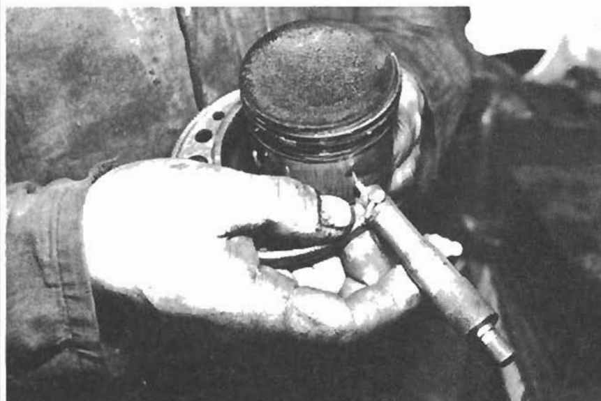
108. Ob man's glaubt oder nicht, auch Kolben können unrund werden. Dies wird nur selten kontrolliert, aber besser wäre es.
