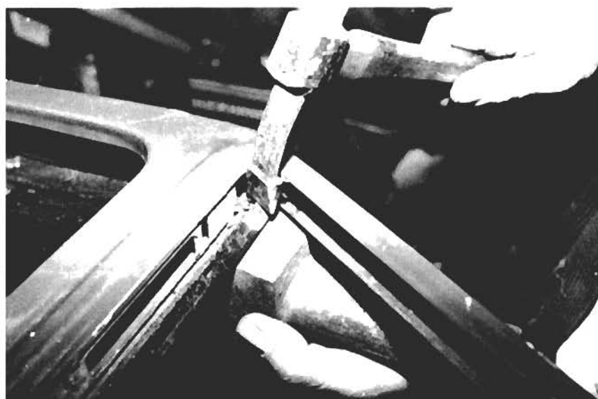
27. Hier macht sich ein vernünftiger Karosseriehammer bezahlt. Mit der gekrümmten Kreuzpinne des Pinnhammers kann auch der letzte Winkel im Fensterausschnitt erreicht werden. Zur Not geht es auch mit einem passend geschnitzten Holzstück, das man in die Vertiefung legt und mit dem Hammer bearbeitet, während ein Helfer die Handfaust von hinten anhält.
