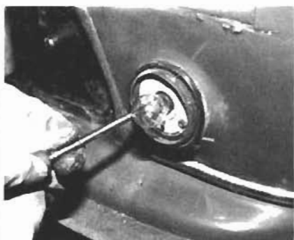
19. Die Glühlampenfassung ist mit drei Blechschrauben befestigt. Bei älteren Minis sitzen die Schrauben aber oft im gähnenden Nichts!
