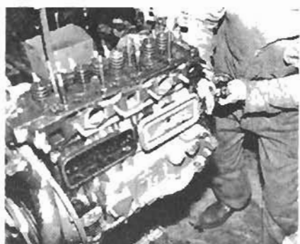
46. Manchmal geht dies nicht so einfach! Wenn der Deckel klebt, wird er NICHT abgehoben, sondern mit einem Meißel von der Kante her abgedrückt.
