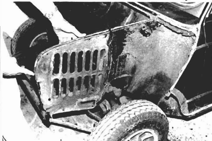
4. Das neue rechte Stehblech wurde auf alt umgestrickt, indem die vorne sichtbare Motorhaubenstütze vom alten auf das neue Blech umgebaut und die Lufteinlaßöffnung zugeschweißt wurde. Beim Anzeichnen und Ausschneiden ist natürlich größte Vorsicht geboten. Am besten legt man das Neuteil auf das Altteil und zeichnet den Ausschnitt genau an.
