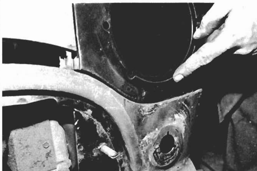
16. Vor der endgültigen Montage kontrolliert man den exakten Sitz des Kotflügels ringsum (oft paßt er erst nach einigem Ziehen, Drücken und Richten so ganz!). Besonders wichtig ist die Passung am Frontblech...
