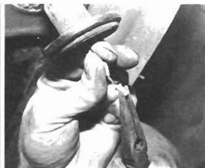
24. ... und lösen die Rundsteckhülsen vom Kabelende, so daß das Kabel durch die Öffnung im Gummi zurückgezogen werden kann. Wollen Sie die Lampen wiederverwenden, schieben Sie die Steckhülsen wieder auf, sonst gehen sie garantiert verloren.
