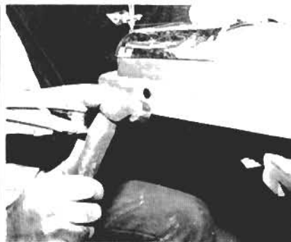
23. Jetzt werden die Ränder umgefälzt. Anfangs hämmern wir sie Stück für Stück nur ein paar Grad weit (maximal 1/3 des vollen Umfanges) um.
