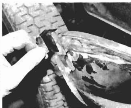
13. An der hinteren Kante mußte eine kleine Durchrostung mit einem Blechstück geschlossen werden. Die ungünstige Lage erschwerte das Arbeiten. Auch hier wurde das Reparaturblech nach einer Pappschablone angefertigt.
