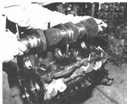
106. Dann kann die Kurbelwelle aus dem Block herausgenommen werden.
